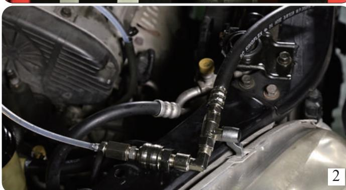
5.8 Una vez se haya extraído el aceite de motor, cierre la válvula de la manguera de succión, y la válvula negra de la máquina, y abra la válvula de drenaje del tanque de 5.5 Litros, (asegúrese que haya un contenedor vacío debajo del tanque de 5.5 litros donde el aceite a drenar sea recibido).
